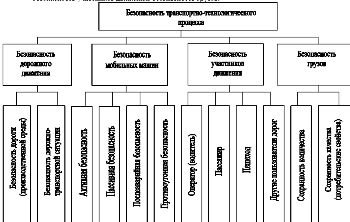
Рисунок 1 - Структурная схема обеспечения безопасности транспортно-технологического процесса
