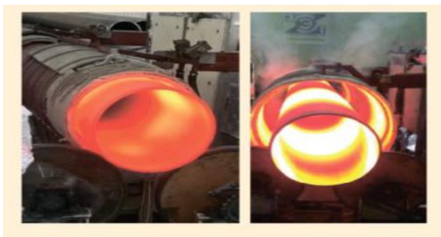
Сурет 2. Құбырларды индукциялық күйдіру.
