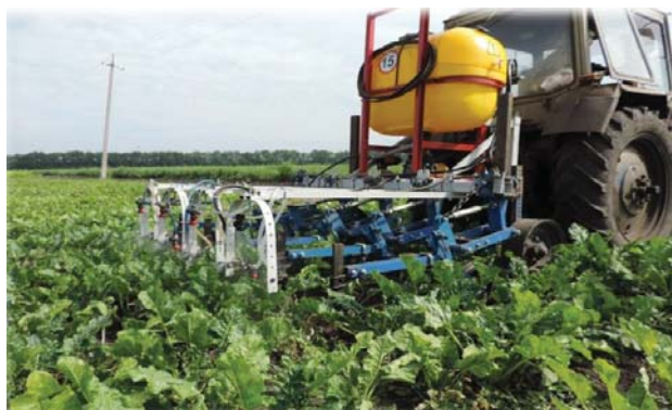
Сурет 1. Қызылша дақылдарын өңдеуге арналған біріктірілген қондырғы.
