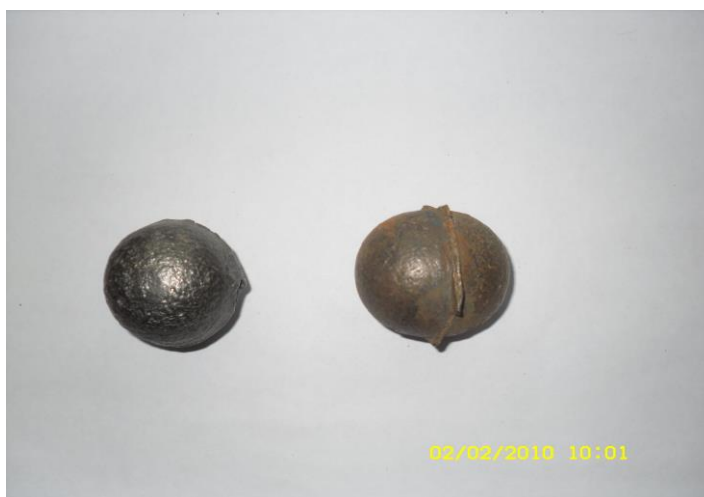
Рисунок 3 – Шары нормальной формы, но недостаточной твердости
